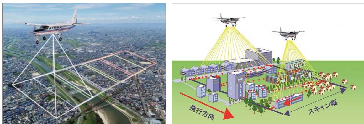
図6. 空中写真測量（左）及び航空レーザ測量（右）のイメージ（出典：国土地理院HP）
