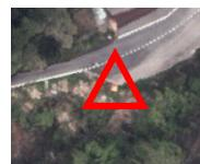
図22 標定点・航測図根点
