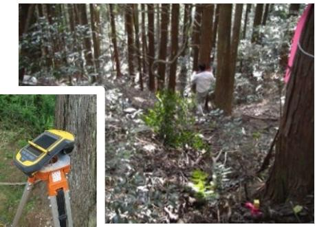
図35 補備測量とD G P S測量機
