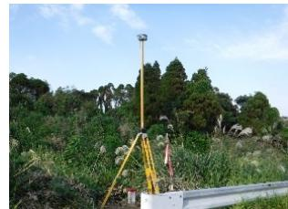
図8 GNSS測量
