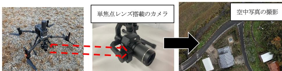
図 IV-9 UAVに搭載するデジタルカメラと撮影した空中写真
